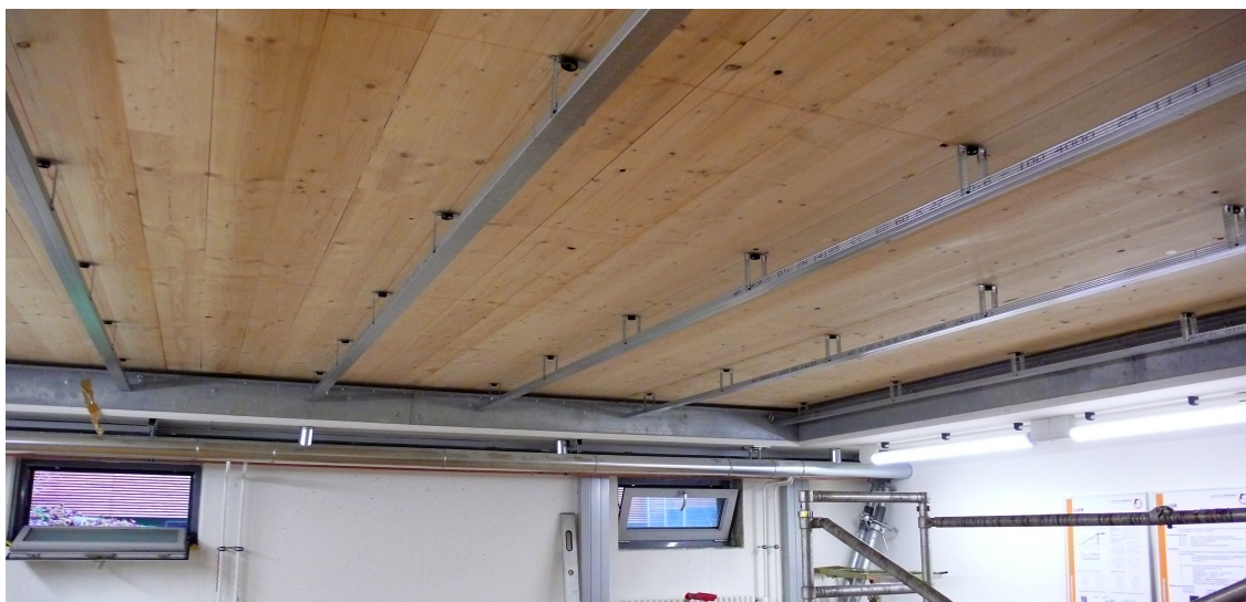
Abbildung 2.6: Deckenprüfstand im Labor für Schallmesstechnik der FH Rosenheim - Ansicht von unten (Die Abhänger für die Montage einer Unterdecke sind bereits installiert) [Winter 2012]
