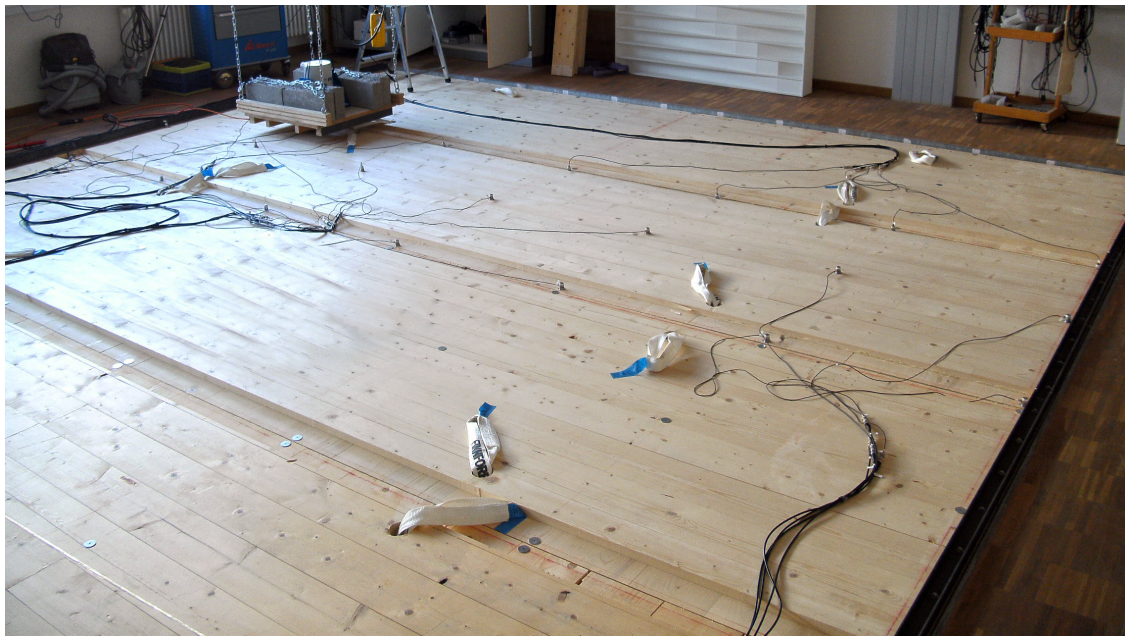
Abbildung 2.5: Deckenprüfstand im Labor für Schallmesstechnik der FH Rosenheim (vorbereitet für die Messung eines einzelnen Deckenelements)
