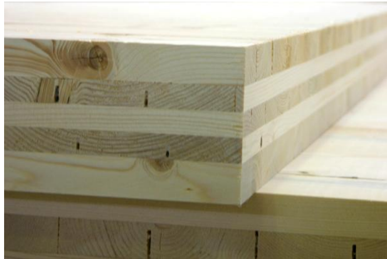
Abbildung 2.4: Schnitt durch eine Brettsperrholzplatte ( www.brettsperrholz.de )
